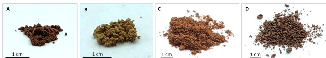
**Figure 147** – A)  $\gamma$ -Fe<sub>2</sub>O<sub>3</sub> nanoparticles, B) 50-poly(*S-r*-canola) particles, C) Blend of A and B, D) Magnetic  $\gamma$ -Fe<sub>2</sub>O<sub>3</sub> nanoparticles encapsulated in 50-poly(*S-r*-canola).
